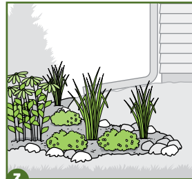
3 Installez un jardin de pluie pour recueillir les eaux pluviales (au moins 5 m de la fondation).
